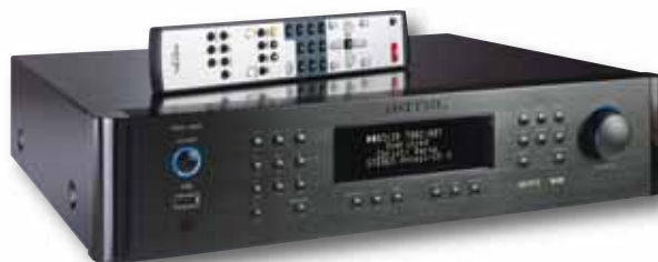
Der Streamer RDG-1520 von Rotel zeigt die Formatunterschiede der Eingänge. Über den Digitaleingang verarbeitet er bis zu 192 Kilohertz. Via Streaming beherrscht er nur 96 kHz und über USB sogar nur 48 kHz.
