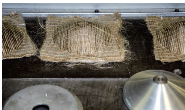
Links ist der Aufbau des Chassis mit dem Flachs zwischen den Glasfasermatten zu sehen, rechts wird der Flachs in Form gebracht.
