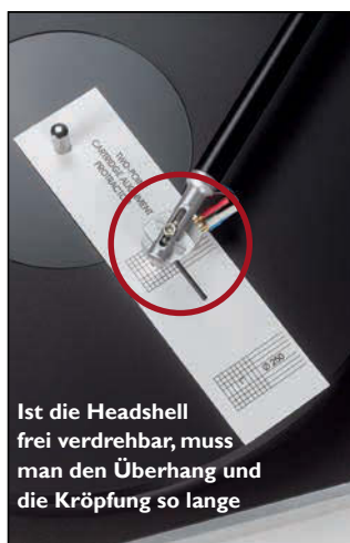
verändern, bis der Nadelträger – wie hier – am Innen- und Außenpunkt der Schablone mit den Hilfslinien fluchtet.
