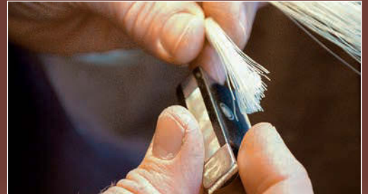
Die Haare werden am Schub des Frosches angebracht, einer kleinen Aussparung, die mit Perlmutter verziert ist. Man muss darauf achten, dass sich die Haare nicht überkreuzen, denn so würden sie leichter reißen. Da Geiger beim Streichen den Bogen meist etwas verkanten, lässt der Bogenmacher an der einen Seite etwas mehr Haare als an der anderen.
