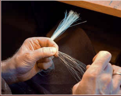
Schönes Haar für schönen Klang: Die Schweifhaare der Hengste sind geeigneter für den Bogenbau als die der Stuten. Sie zu sortieren ist allerdings eine mühselige Angelegenheit...
