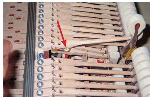
Röllchen aus Hirschleder (siehe Pfeile) befinden sich am unteren Ende der Hammerstiele (Foto unten: Detailansicht). Da dort die größte Reibung entsteht, lohnt es sich, diese Röllchen zu pudern, um das Spielgefühl für Pianisten geschmeidiger zu machen.
