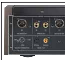
Das Musiksinal kann am Yamaha-Player analog symmetrisch (XLR), unsymmetrisch (Cinch) sowie digital via Koaxbuchse abgenommen werden.
