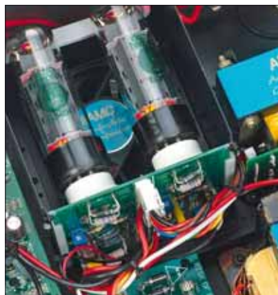
Sowohl beim CD-Spieler XCDi-vt (ganz links) wie auch beim Vollverstärker-Modell CVT 3030 MK 2 von AMC (links) sorgen Röhren für ein farbiges Klangbild.
