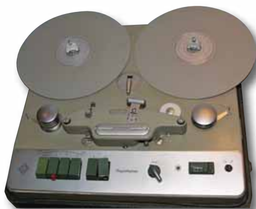
Schwestermodell des Studio-Bandgerätes, mit dem Keith Jarretts legendäres „Köln Concert“ aufgenommen wurde: Telefunken Magnetophon M5.
