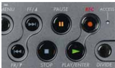
Klassische Laufwerkssteuerung mit farbigen Leuchtsymbolen in den Tasten.
