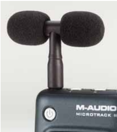
M-Audios Beipack-Mikrofon wird in die Miniklinkenbuchse gesteckt.
