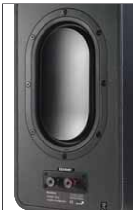
Die Lautsprecher der Audio Pro sind mit je einer rückwärtigen Passiv-Membran bestückt, die wie eine Bassreflexöffnung wirkt.
