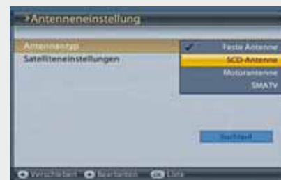
Moderne DVB-Empfänger sind meist für das Einkabelsystem („SCD“) vorbereitet.
