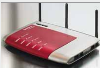
Ein „Router“ steuert die Kommunikation im Netzwerk.
