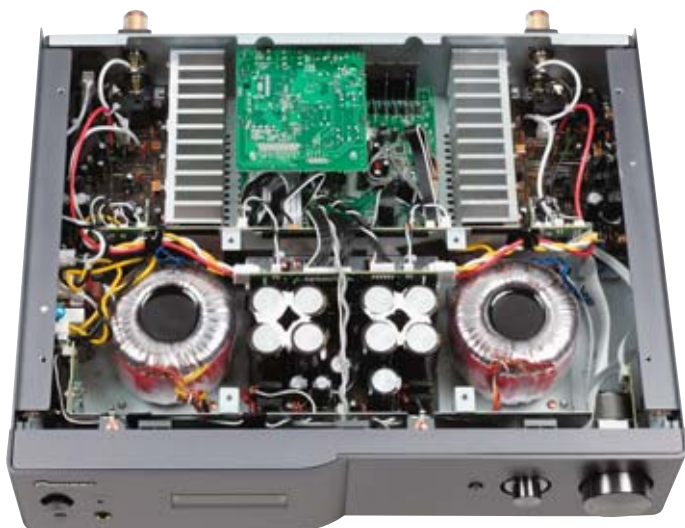
Deutlich erkennt man die zwei Netzteile des Verstärkers A 9, die beide Stereokanäle separat versorgen.
