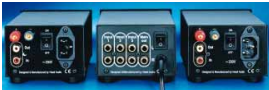
Drei Eingänge und ein Main-out für die Endstufen-Befuerung – mehr hat die Heed-Vorstufe (Mitte) nicht vorzuweisen. In den meisten Fällen dürfte das aber genügen.
