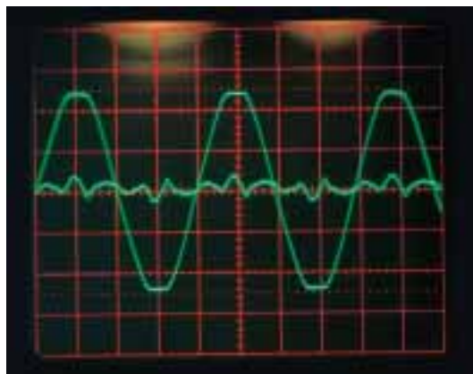
Das Foto unseres Oszilloskops zeigt es deutlich: Mit einer Sinuskurve hat der Strom aus der Steckdose nicht mehr viel zu tun. Die zackige Linie in der Mitte sind übrigens isolierte Verzerrungsanteile.
