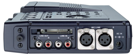
Tascam HD-P2: ähnliches Anschlussfeld wie bei Marantz, aber Firewire statt USB. Grafik-Display mit professioneller Aussteuerungsanzeige (Fotos unten). Die Auflösung – bis zu 192 kHz/24 Bit – wird im Projekt-Menü voreingestellt.
