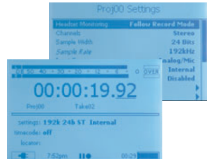
Tascam HD-P2: ähnliches Anschlussfeld wie bei Marantz, aber Firewire statt USB. Grafik-Display mit professioneller Aussteuerungsanzeige (Fotos unten). Die Auflösung – bis zu 192 kHz/24 Bit – wird im Projekt-Menü voreingestellt.
