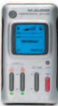
Ideal für ambulante Aufnahmen: Profi-Flashkarten-Recorder Tascam HD-P2 (oben, 1.150 Euro). Aber auch der Micro Track von M-Audio (links, 480 Euro) kann via Line-, Mikrofon- oder SPDIF-Eingang in PCM mit bis zu 24 Bit/96 kHz aufnehmen.
