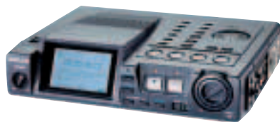
Ideal für ambulante Aufnahmen: Profi-Flashkarten-Recorder Tascam HD-P2 (oben, 1.150 Euro). Aber auch der Micro Track von M-Audio (links, 480 Euro) kann via Line-, Mikrofon- oder SPDIF-Eingang in PCM mit bis zu 24 Bit/96 kHz aufnehmen.
