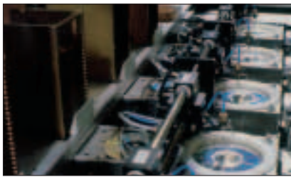
Bei der CD-Fertigung wird ein Schutzlack auf die Aluminiumschicht aufgetragen, der das Eindringen von Schadstoffen verhindern soll.
