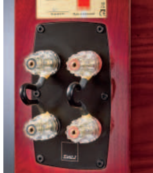
Das edle Terminal ist mit Kabelbrücken bestückt.
