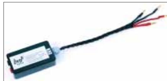
Ein Bi-Wiring-Adapter (hier von BVU) verteilt die Signale auf alle vier Anschlüsse und belebt dadurch auch den Klang eines Lautsprechers.
