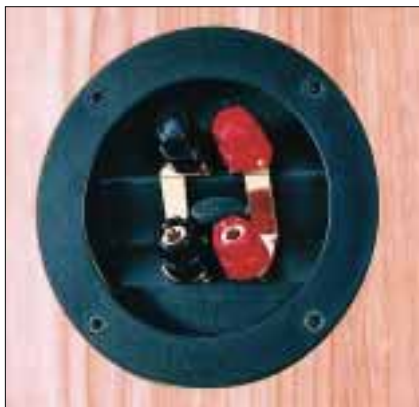
Die einfachste Form eines Terminals ist das Single-Wire-Terminals (rechts). Das Lautsprecherkabel wird einfach in die beiden vorhandenen Buchsen gesteckt (oder eingeschraubt), die weitere Signalführung erfolgt über Kabel im Inneren des Lautsprechers.
