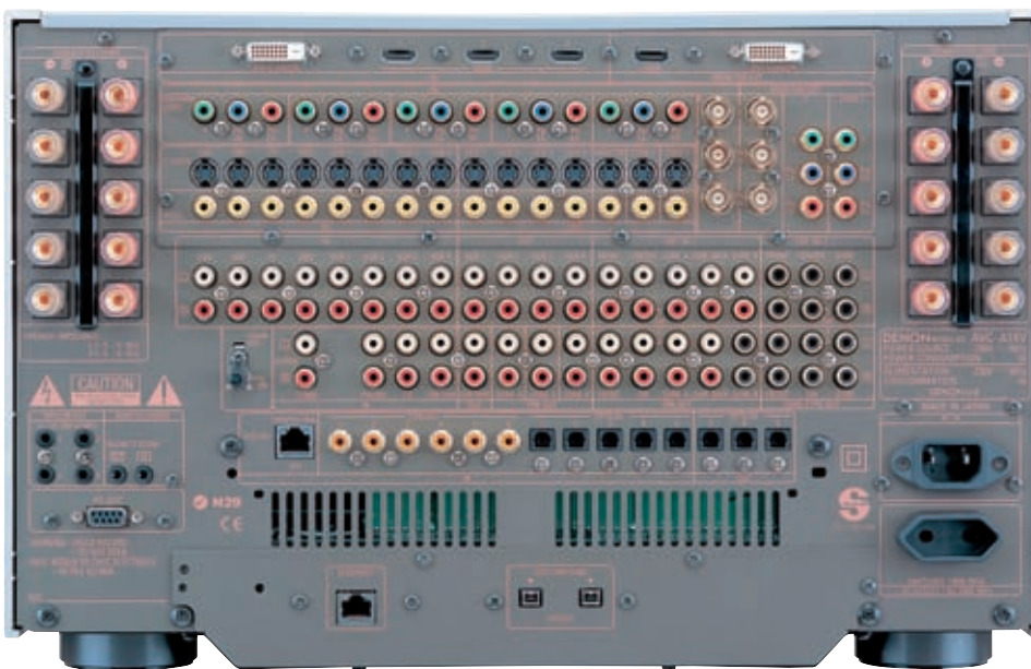
Vielfältig, aber übersichtlich: Ganz oben die HDMI- und DVI-Buchsen, darunter die analogen Video-Schnittstellen, in der Mitte die analogen Audio-Ein- und Ausgänge. Im unteren Bereich folgt die Digital-Audio-Sektion mit SPDIF-, Denon-Link- und i-link-Buchsen. Links und rechts die hochpräzisen, vergoldeten Schraub-/Bananklemmen für die Lautsprecher.
