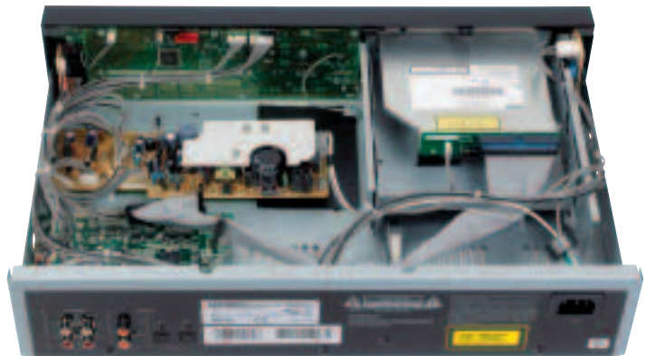
Superschlanker Teac-Brenner, kompakte Audio- und Steuerungselektronik, Anschlüsse für Cinch und digital-optisch: Tascam CD-RW 900.
