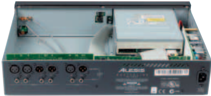
Die Festplatte sitzt unterm Brenner: luftiges Alesis-Interieur. Analoge wie digitale Ein- und Ausgänge stehen in Cinch und XLR bereit.
