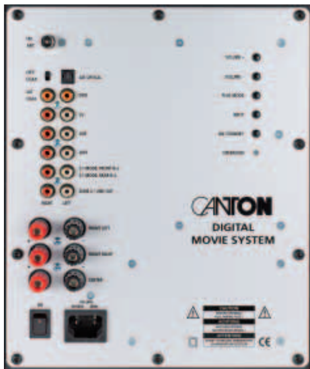
Der Verstärker im Subwoofer bietet reichlich Ein- und Ausgänge und hat kleine Tasten (oben rechts) zur rudimentären Bedienung.
