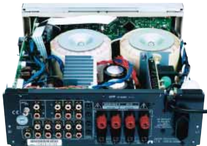
Zwei mächtige Ringkerntrafos bilden die Basis für die unglaublichen Leistungsreserven des A-933. Der Kühlkörper kann dagegen klein ausfallen – dank Digitalendstufe mit geringer Verlustwärme.
