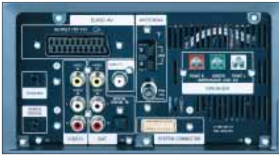
Das Anschlussfeld im Fuß des Subwoofer: Die drei Lautsprecherstecker sind farbig markiert, das Bedienteil wird über einen einzigen Vielfachstecker angestöpselt.
