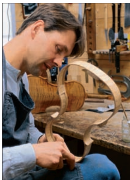
Einblicke ins Holzlager (ganz oben) und in die Werkstatt – vom Abstechen der Wölbung über das Zulimmen des Korpus bis zum Schnitzen der Schnecke. Auf dem Foto links wird am Zargenkranz gearbeitet.
