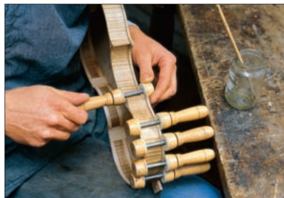
Einblicke ins Holzlager (ganz oben) und in die Werkstatt – vom Abstechen der Wölbung über das Zulimmen des Korpus bis zum Schnitzen der Schnecke. Auf dem Foto links wird am Zargenkranz gearbeitet.
