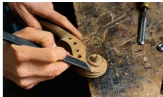
Einblicke ins Holzlager (ganz oben) und in die Werkstatt – vom Abstechen der Wölbung über das Zulimmen des Korpus bis zum Schnitzen der Schnecke. Auf dem Foto links wird am Zargenkranz gearbeitet.
