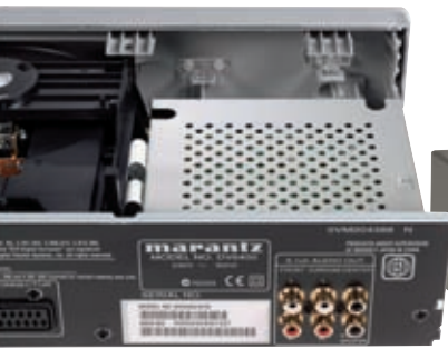
Das simple Marantz-Display gibt kaum Disc-Informationen preis. Die Audio-Elektronik hat Marantz sorgfältig im Metallkäfig untergebracht (Bild links).
