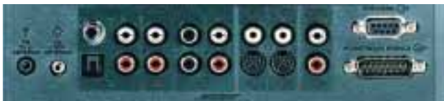
Analog- und Digitaleingänge für drei Audio-Quellen, ein Video-Eingang, Miniklinke für die UKW-Antenne: das Anschlussfeld des Bose DVD-Receivers.
