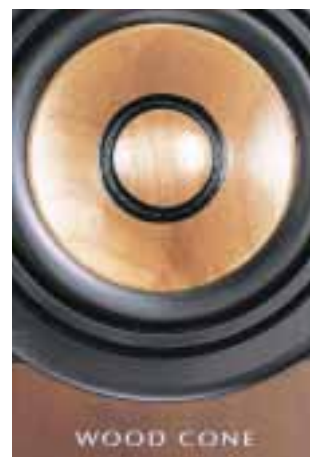
Dünne Birkenholzscheiben werden in Reiswein getränkt, damit sie beim Stanzen nicht brechen: JVC-Lautsprecher mit Echtholzmembran.
