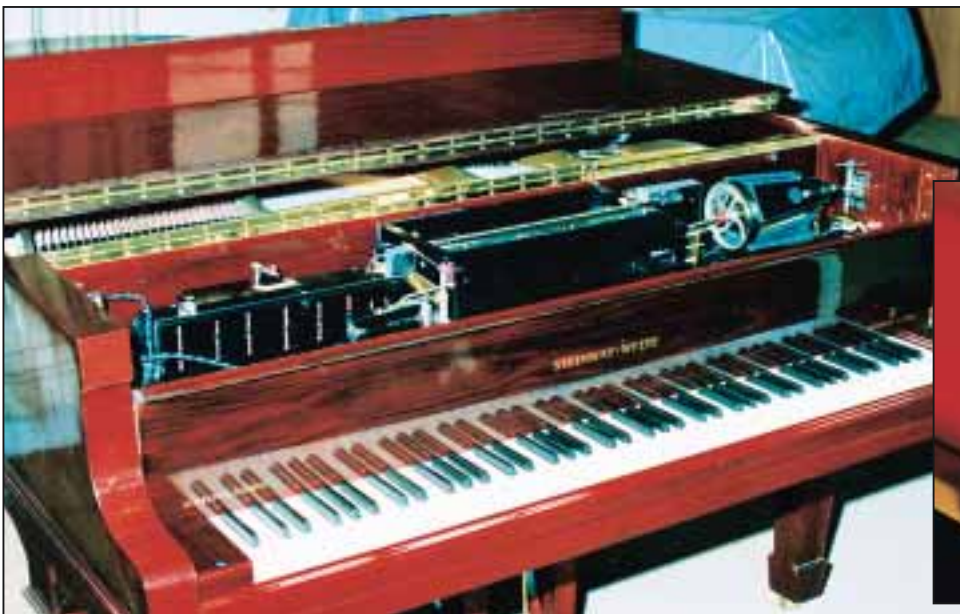
Ein Steinway-Flügel mit eingebautem Welte-System (l.). Das Foto unten zeigt das Lochstreifen-Prinzip im Detail.
