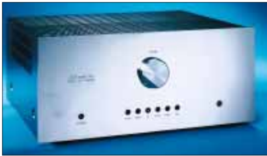
Der Lua 6060 Diva leistet mit vier KT-88-Endröhren zweimal 60 Watt.
