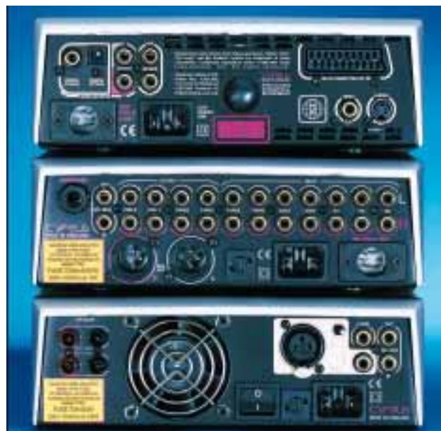
Anschlüsse satt: besonders komfortabel die zahlreichen Anschlussmöglichkeiten am Vorverstärker aCA 7.5 sowie die symmetrischen Ein- und Ausgänge.
