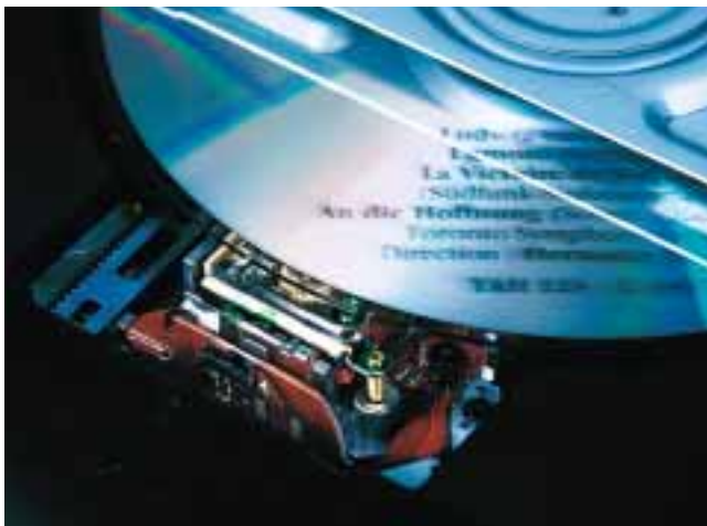
Eine herkömmliche CD wird im DVD-Player mit einem Infrarot-Laser ausgelesen.
