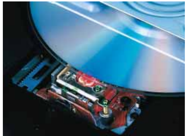
Zum Abtasten einer DVD verwendet der Player sichtbares Rotlicht. Somit können moderne Player beide Formate bedienen.
