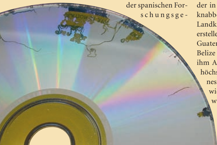
Geotrichum hinterlässt in den von ihm befallenen CDs charakteristische Fraßspuren.
