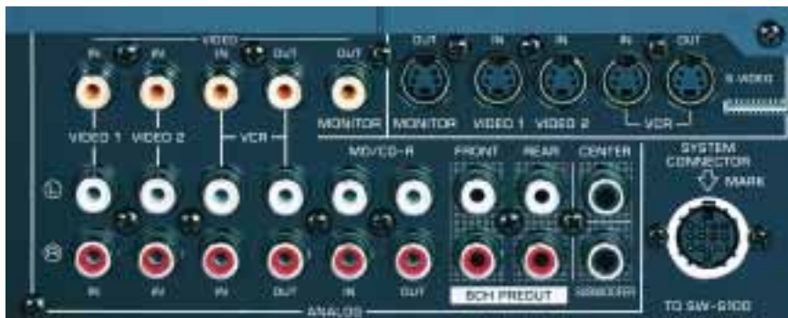
Dank zahlreicher Anschlüsse auf der Rückseite lassen sich viele analoge und digitale Geräte in den Signalweg der Yamaha DVX-S 100 einschleifen.
