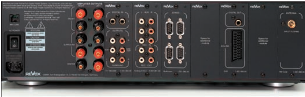
Insgesamt sieben Einschübe bietet der modular aufgebaute M51: Je nach Kundenwunsch können Tuner-, DVD-, Multiroom-, oder analoge I/O-Module integriert werden.
