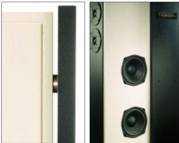
Die MDF-Platten, die durch Anregung der Chassis mitschwingen, werden in einem definierten Abstand montiert. Dahinter befinden sich je nach Modell ein oder mehrere Tieftöner
