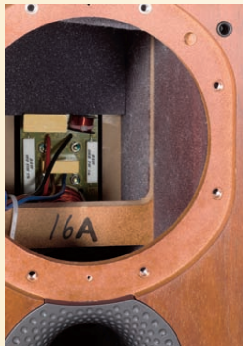
Hinter dem Tieftöner direkt im Zugriff: die mit hochwertigen Bauteilen, aber wohl-tuend überschaubar und damit verlustarm bestückte Weiche.
