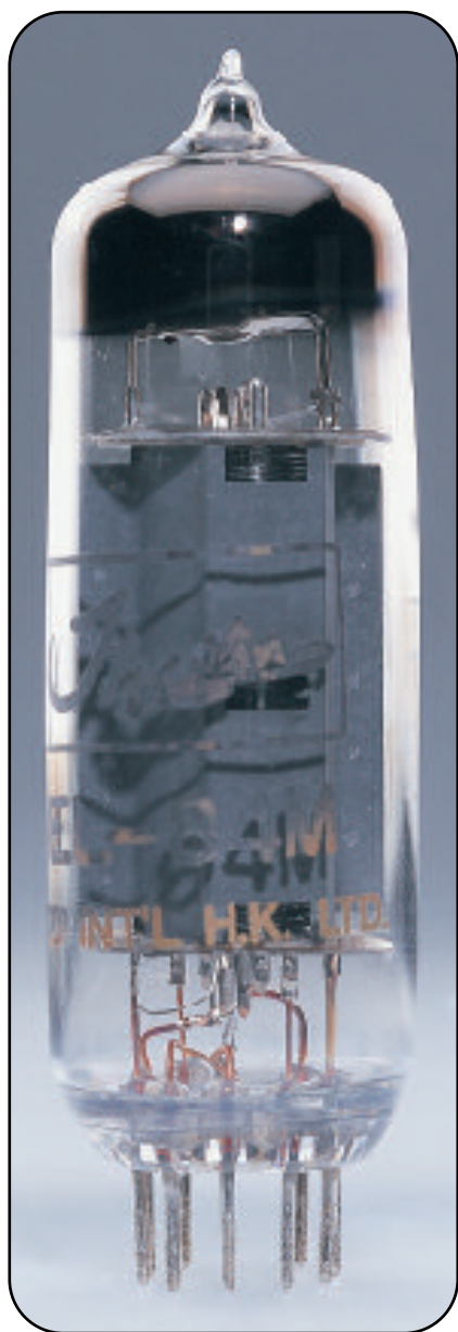
Eine der bekanntesten Endröhren der Unterhaltungselektronikgeschichte: die Pentode vom Typ 6X4P. Sie saß bis in die 60er Jahre im Ausgang praktisch jeden Radios.
