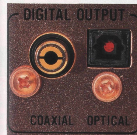
Cinch-Buchsen und Toslink-Lichtleiter für den normalen digitalen Datenaustausch...
