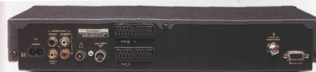
Die Anschlüsse der Pace-Box: Analoge HiFi-Ausgänge und eine RS-232-Computerschnittstelle.
