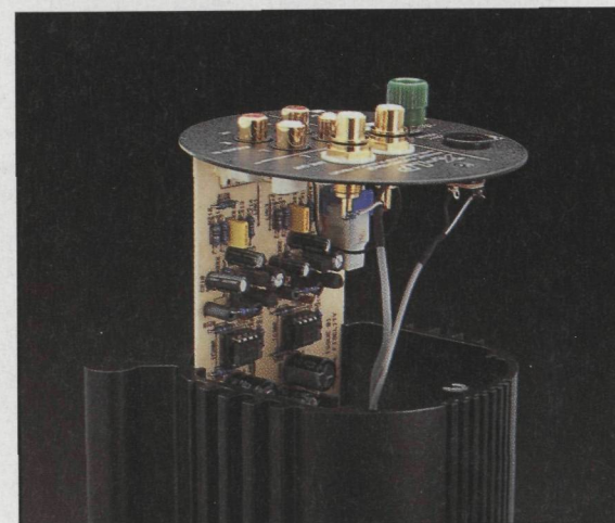
Auch im X-LP verstärken moderne integrierte Bausteine die Signale.
