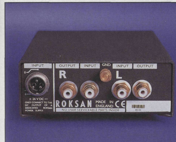
So einfach gestaltet sich der Anschluß: zwei Eingangsbuchsen, zwei Ausgangsbuchsen und ein Anschluß fürs Netzteil.
