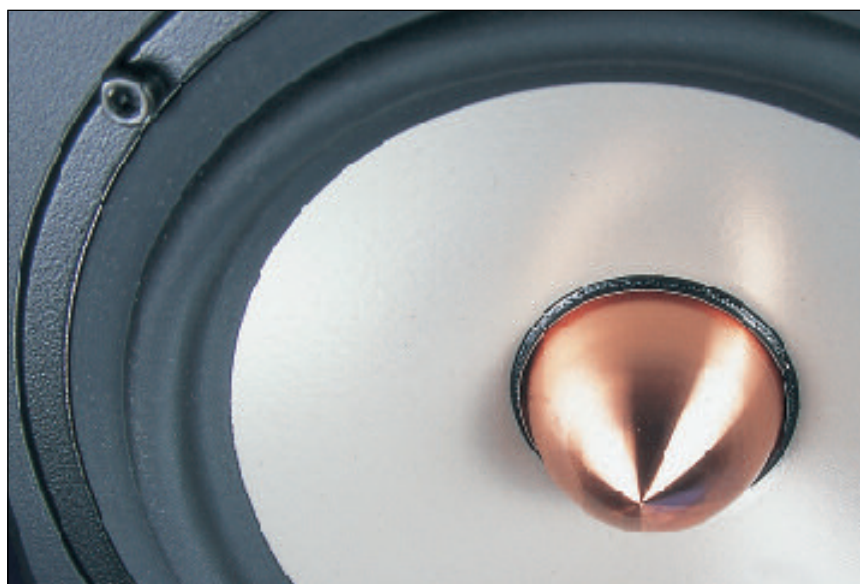
Die massive Kupfer-„Nase“ treibt dem Tieftöner Unregelmäßigkeiten bei höheren Frequenzen aus. Gut zu sehen: Die Magnesium-Druckgußmembran.
