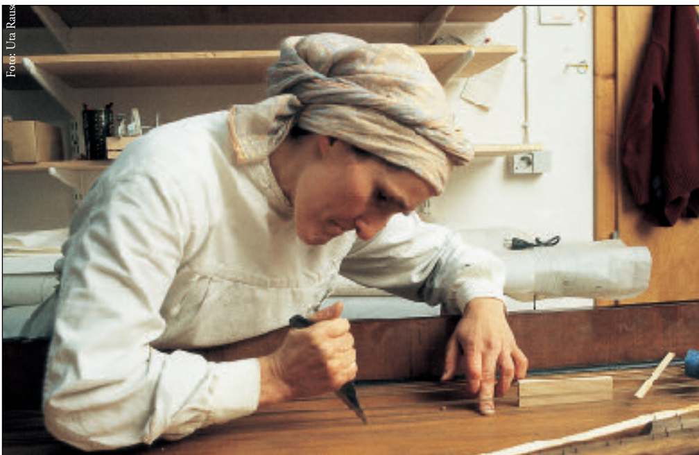
Monika May in ihrer Werkstatt: Hier setzt sie einen Span in eine Rißstelle im Resonanzkörper ein.
