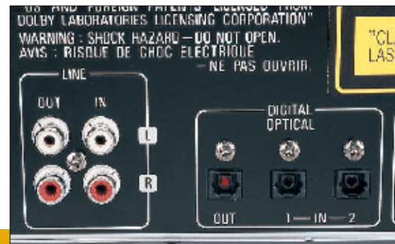
Anschlußfeld des MD-Recorders: Digitale Quellen können nur via Lichtleiterkabel angestöpselt werden.
