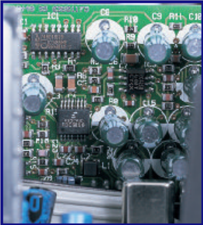
Hochwertige Digital/Analog-Wandler : Lemon verwendet einen Chip von Analog Devices (oben), im Kathrein-Receiver steckt ein Crystal-Wandler (rechts).
