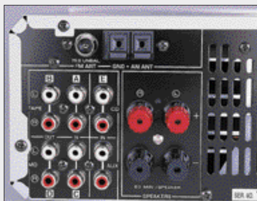
Ordentliche Lautsprecherklemmen und alle wichtigen Cinch-Anschlüsse sind vorhanden – nur der Phono-Eingang fehlt. Wichtig für Digitalaufnahmen: der optische Digitalausgang am CD-Player. Einen passenden MiniDisc-Recorder bietet Yamaha für 600 DM an.
