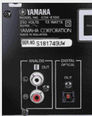
Ordentliche Lautsprecherklemmen und alle wichtigen Cinch-Anschlüsse sind vorhanden – nur der Phono-Eingang fehlt. Wichtig für Digitalaufnahmen: der optische Digitalausgang am CD-Player. Einen passenden MiniDisc-Recorder bietet Yamaha für 600 DM an.
