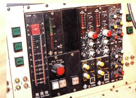
Übliche Praxis nicht nur der meisten privaten Radiosender: Dynamikkompression mit Hilfe eines Optimod-Gerätes. Der Summen-Meter fällt kaum je unter zehn Dezibel.
