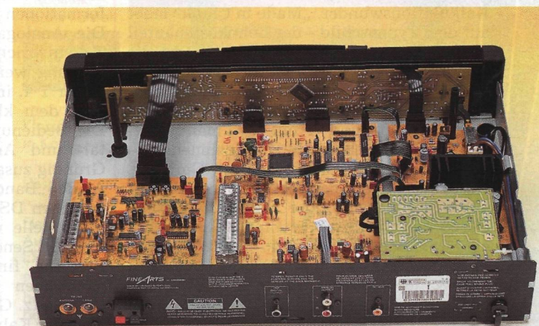
Der Blick ins Innere des Amstrad DSR 100 zeigt links das Frontend für Satellit, rechts für Kabel. Am Rückteil der optische und coaxiale Digitalausgang (oben). Sauber getrennt bei Grundig: Links die UKW-Abteilung mit Frontend auf eigener Platine. In der Mitte die DSR-Platine mit Kabeltuner. An der Rückseite der coaxiale Digitalausgang (unten).
