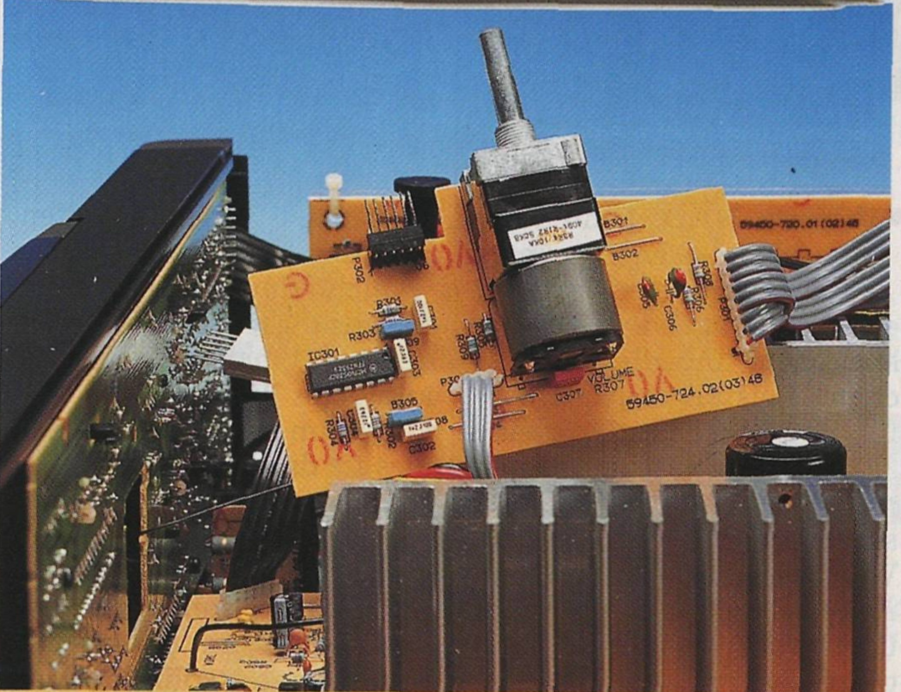
Die gute Verarbeitung des Grundig verspricht langjährigen problemlosen Betrieb: Ein staubdicht gekapseltes Motorpoti wie hier beim V2 ist in dieser Klasse eine Seltenheit.
